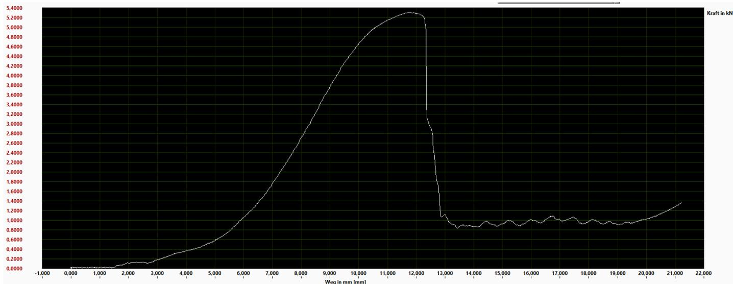
**Ergebnis: Bruchlast bei 5,3kN, Schraube aus Holz gezogen. Mastplatte nur wenig verbogen.**
