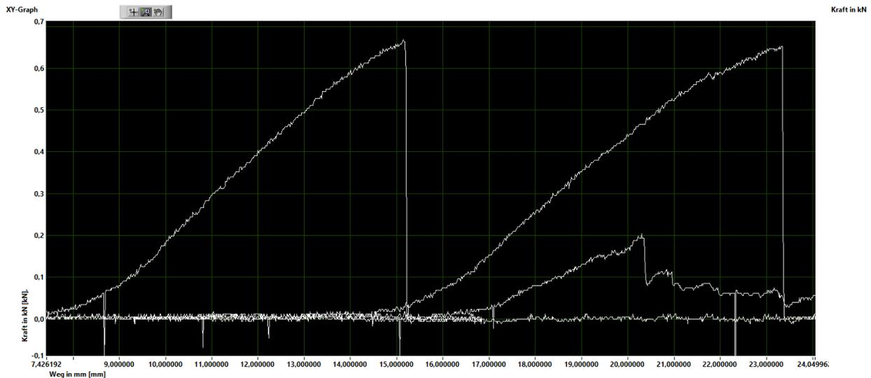
**Ergebnis: Bruchkraft min. 0,62kN, MBK von 0,61kN erreicht. Es gab auch Versuche mit Bruchwerten Von 0,38kN, daher Nutzlast von 8kg bei fünffachem Sicherheitsfaktor.**
