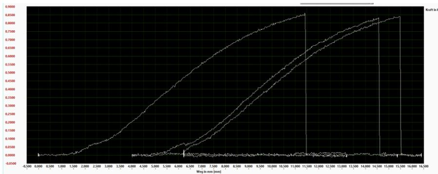
**Ergebnis: Kleinste Bruchkraft= 0,82kN, MBK von 0,61kN überschritten.**
