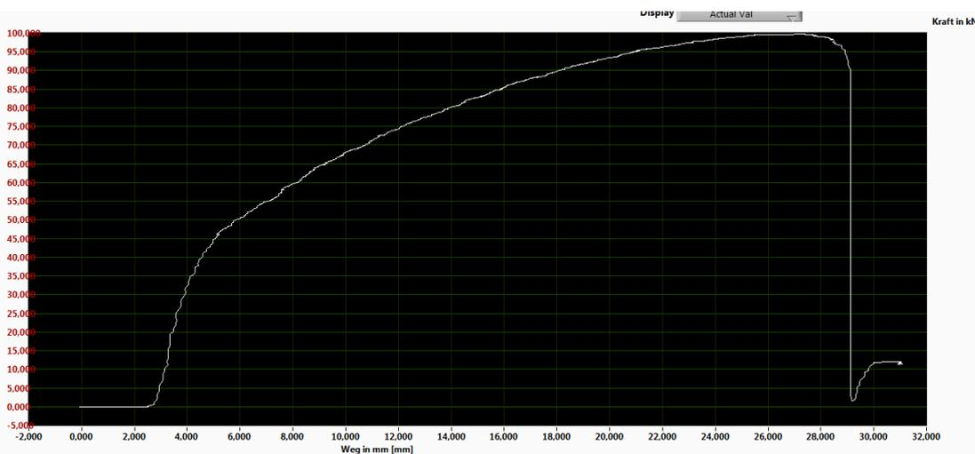
**Ergebnis: Beginn der plastischen Verformung bei ca. 45kN, Öse aufgerissen bei 99kN, Nutzlast bei Sicherheitsfaktor 5 = 1.500kg.**
