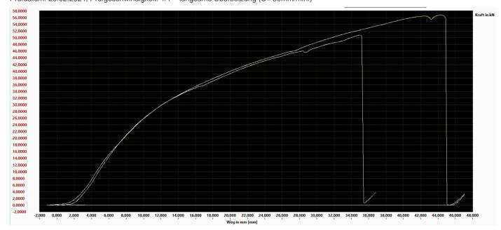
Ergebnis: Min. Bruchkraft ca. 50,3kN, Ausriss des Gewinde vom Augbolzen an der Kugel.
