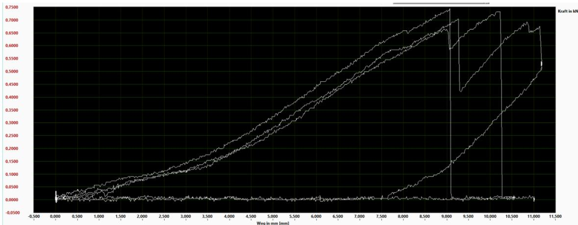
**Ergebnis: Bruch des Drahtseils innerhalb der Klemme min. 0,65kN, MBK des Drahtseils von 0,76kN nicht erreicht. Nutzlast max. 13kg bei fünffachem Sicherheitsfaktor**
