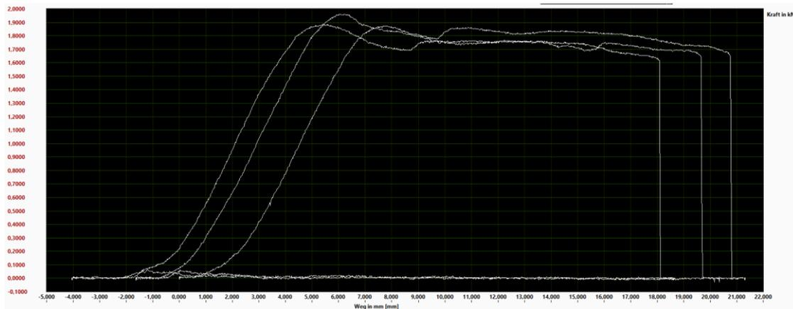
**Ergebnis: Aufbiegen des Hakens bei 1,3kN, Nutzlast max. 26kg bei fünffachem Sicherheitsfaktor**
