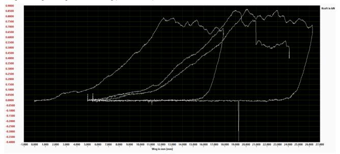
Ergebnis: Einmal Seilbruch im Drahtseilhalter, zweimal rutscht das Seil durch bei min. 0,77kN. MBK von 1,71kN nicht erreicht. Nutzlast max. 15kg bei fünffachem Sicherheitsfaktor.
