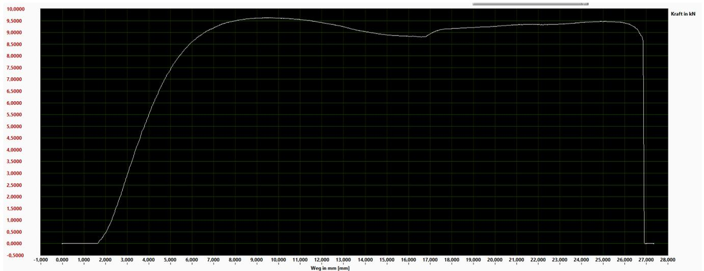
**Ergebnis: Öffnung eines Hakens am Spansschloss bei 7,5kN. Max. Nutzlast 150kg bei 5-fachen Sicherheitsfaktor.**
