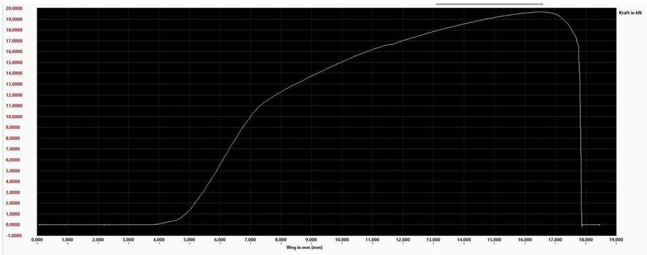
**Ergebnis: Beginn der plastischen Verformung bei ca. 10kN, Gewindeabriss bei 19,5kN, Nutzlast bei Sicherheitsfaktor 5 = 280kg.**
