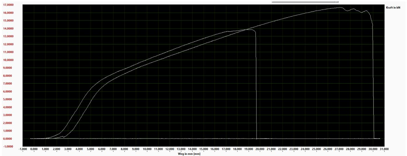
**Ergebnis: Bruch bei min. 13,5kN. Drehwirbelbolzen abgerissen.**
