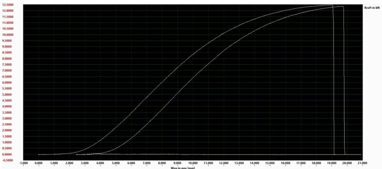
**Ergebnis:** Zweimal Seilbruch am Pressklemmenausgang bei ca. 12,3kN. MBK in Höhe von 9,09kN überschritten. Nutzlast bei fünffachem Sicherheitsfaktor: 160kg.
